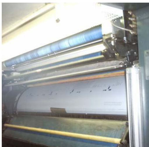
印刷机使用的湿布清洗滚筒，可减少 VOC 排放
