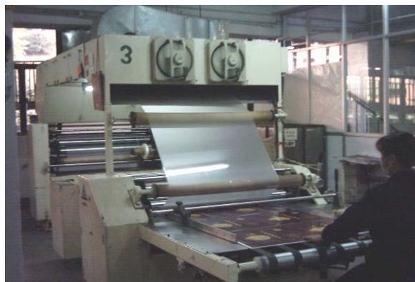
水溶性胶水可减低覆膜工序的 VOC 排放
