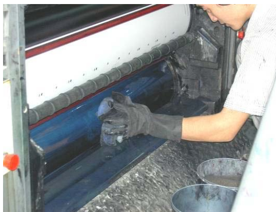
使用低挥发性的洗车水，可减少 VOC 排放
