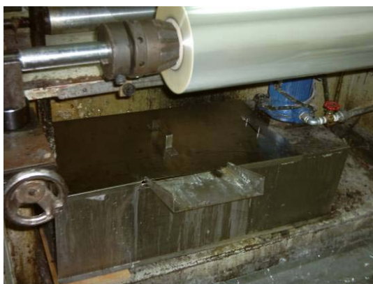
覆膜机的胶水槽及涂胶部份排放 VOC
